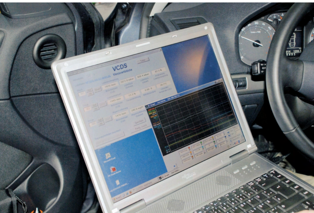
Ansichtssache: Das Diagnosetool ,VCDS 805.1' ist ausschließlich als PC- beziehungsweise Laptoplösung erhältlich. Angewählte Steuergeräteparameter lassen sich alphanumerisch, aber auch graphisch darstellen. Bilder: Schmidt
